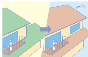
2階に1部屋を増床 (柱・梁・屋根・壁等の新設)
