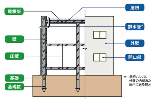
**雨水の浸入を防止する部分**
