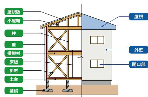
雨水の浸入を防止する部分
